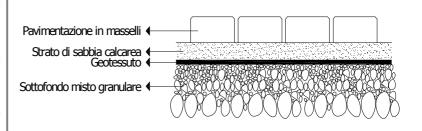
Se il sottofondo non è perfettamente idoneo, si consiglia di inserire, prima della stesura dello strato di sabbia, il geotessuto: è un materiale particolarmente utile per il drenaggio e il filtraggio dei liquidi, per separare e impedire il trascinamento della sabbia e in fine per rinforzare e proteggere il sottofondo.
